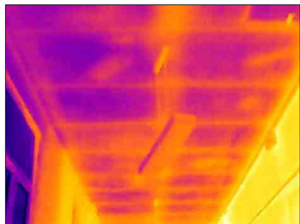
Foto n°3-4 - Individuazione della tramatura caratteristica dell'intradosso del Corridoio al piano primo. Gli elementi portanti sono caratterizzati da una colorazione più chiara mentre il sistema di alleggerimento è contraddistinto da tonalità più scure.
