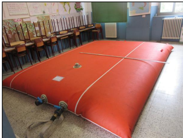
Foto n°2 - Posizionamento del serbatoio all'estradosso del solaio dell'Aula 6 al piano primo.
