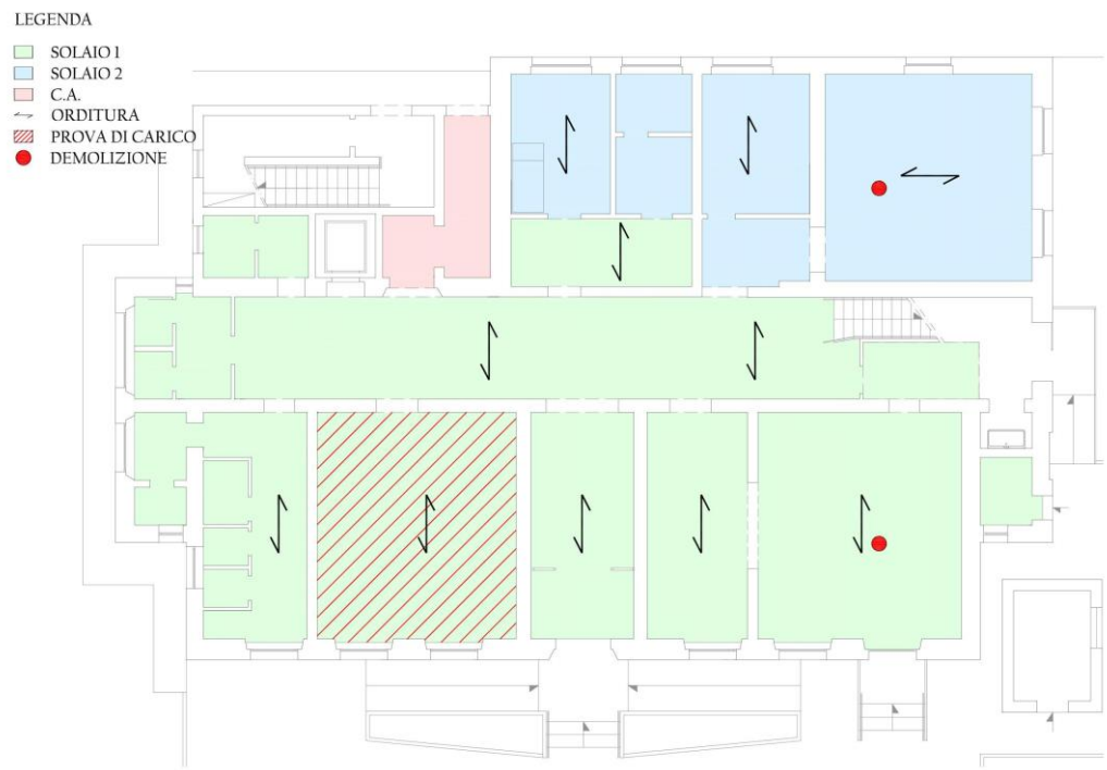
Disegno n°2 - Planimetria dell'impalcato di calpestio del primo piano - Individuazione tipologie costruttive in cui sono riportati i punti di rilievo ed i solai oggetto delle prove di carico.
