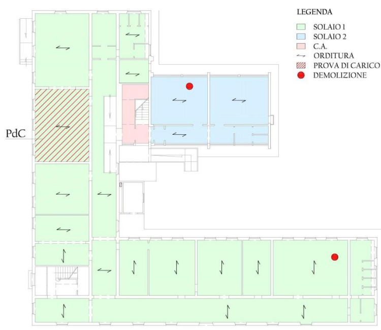
Disegno n°2 - Planimetria dell'impalcato di calpestio del primo piano - Individuazione tipologie costruttive in cui sono riportati i punti di rilievo ed i solai oggetto delle prove di carico.
