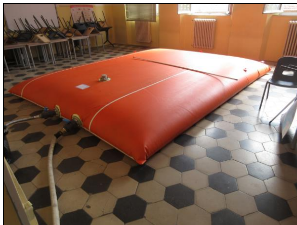
Foto n°2 - Posizionamento del serbatoio all'estradosso del solaio dell'Aula 2 al primo piano.
